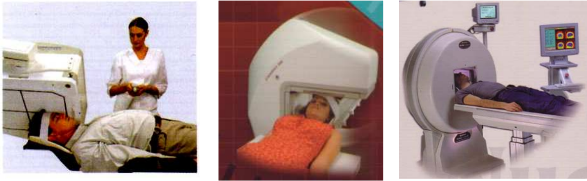
Hình 4.33: Ghi hình não bằng máy SPECT 1 đầu (ảnh trái), 2 đầu hình chữ V cố định (ảnh giữa), với máy SPECT-PET 4 đầu (ảnh phải)
